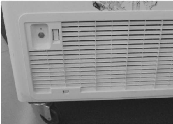
Die Werkseinstellung des Thermostats liegt bei  $-20\text{ }^{\circ}\text{C}$ , die ideale Temperatur für Speiseeis ist  $-18\text{ }^{\circ}\text{C}$ . Der Thermostat kann zwischen  $-14\text{ }^{\circ}\text{C}$  und  $-24\text{ }^{\circ}\text{C}$  eingestellt werden. Drehe es im Uhrzeigersinn, um die Temperatur zu senken.
